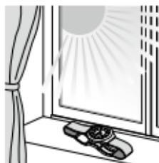
Las prendas de ropa que cubren el reloj pueden impedir que la esfera reciba la cantidad suficiente de luz, lo que conllevará una carga insuficiente.
