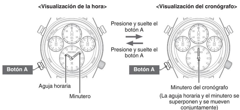
\* Al alternar entre "visualización de la hora" y "visualización del cronógrafo", la aguja horaria, el minutero y la aguja del cronógrafo se mueven.
