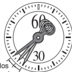
La manecilla de segundos comienza a moverse en intervalos de 2 segundos, cuando el reloj es cargado permitiendo que la luz incida sobre la celda solar. Sin embargo, como el reloj se ha parado como resultado de estar con una carga insuficiente, la hora no está correcta. Cargue suficientemente el reloj hasta que la manecilla de segundos comience a moverse en intervalos de 1 segundo, y luego reposicione la hora antes de usar el reloj.
